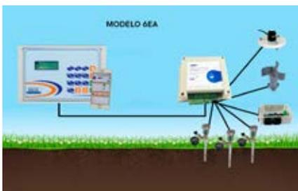
**Ampliación 6 sensores analógicos (6EA):** Permite conectar hasta 6 sensores analógicos en las entradas analógicas del módulo ampliación.
