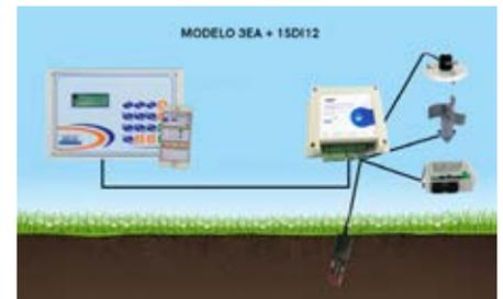
**Ampliación 3 sensores analógicos y 1 tri-sensor SDI12 (3EA + 1SDI):** Permite conectar 3 sensores analógicos en las entradas analógicas y 1 sonda tri-sensor SDI-12.
